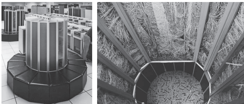
Рис. 16. Суперкомпьютер Cray-1 снаружи (слева) и внутри (справа)
